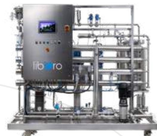
Entrambi utilizzano la medesima tecnologia all'avanguardia con membrane semipermeabili altamente selettive che permettono la separazione dell'alcol dal vino a temperatura ambiente, evitando qualsiasi stress termico e preservando al massimo gli aromi.
