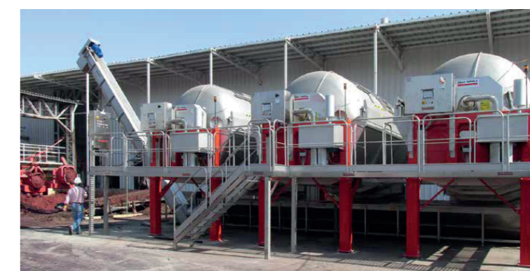
Impianto presse pneumatiche tank aperto, Cile
