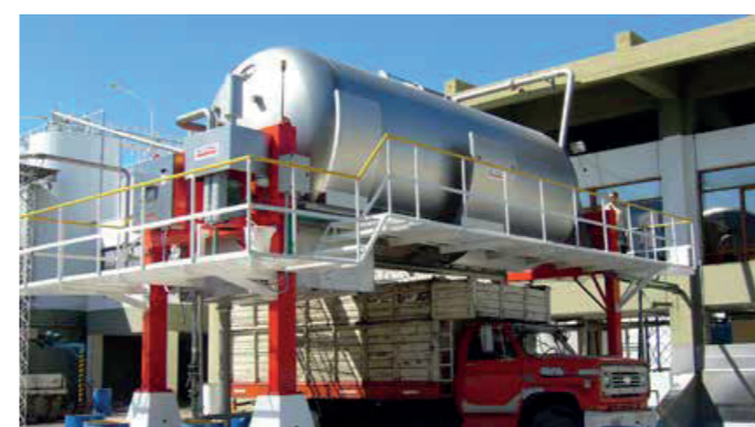
Impianto presse pneumatiche tank chiuso, Argentina
