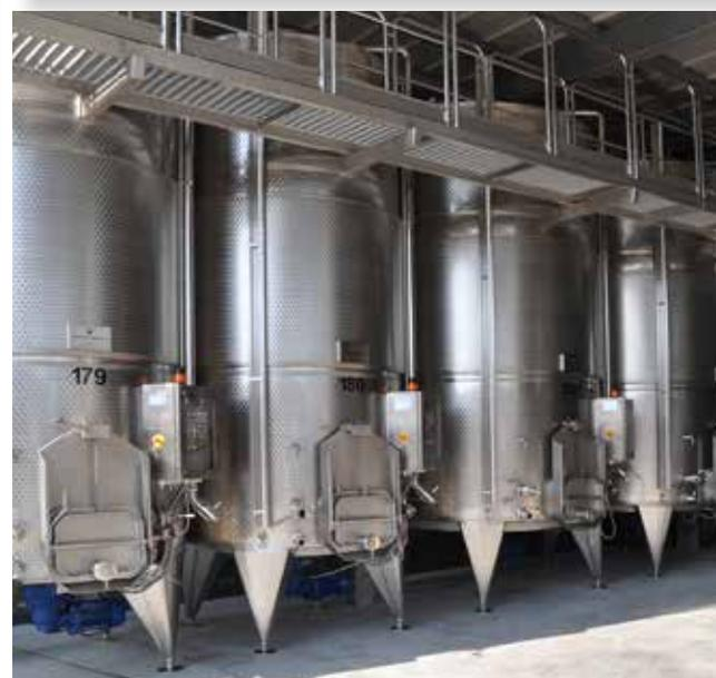
Le nostre autoclavi sono particolarmente apprezzate per la capacità di **controllo totale, e l'autonomia di gestione del ciclo fermentativo**, con dosaggio dei nutrienti, controlli di pressione e controllo della Co2.
